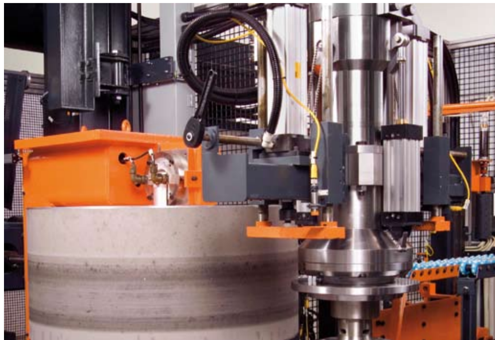
Die Astec Plus-Maschinen zur Gleichförmigkeitsmessung von Reifen können Abweichungen der Radialkraft und der Lateralkraft messen
